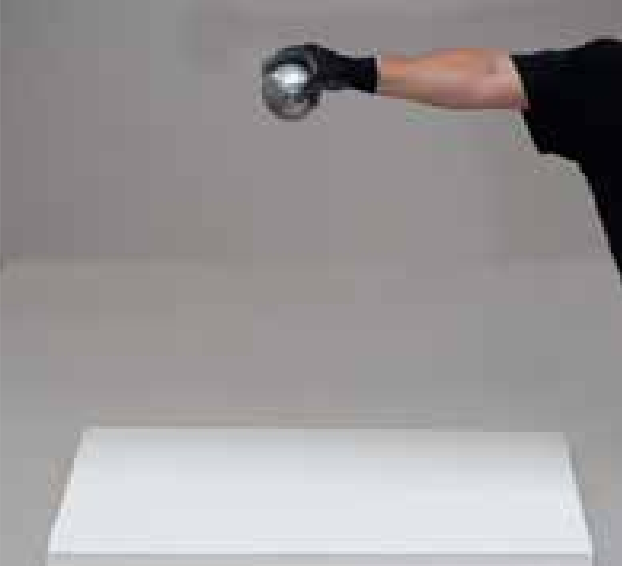
Test pokazujący odporność mechaniczną: uderzenie kulą o wadze 5 kg z wysokości 2 m
